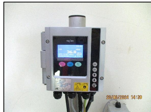
ภาพที่ 2.16 เครื่องตรวจวัดซีโอดีอัตโนมัติ (Auto COD) บริเวณรางระบายน้ำทิ้ง
