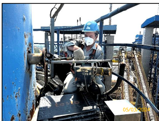
ภาพที่ 3.13 การตรวจวัดก๊าซออกไซด์ของไนโตรเจน (NO x as NO 2 ) บริเวณปล่อยระบายจากหม้อไอน้ำ
