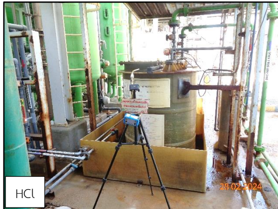
ภาพที่ 3.104 การตรวจวัดไฮโดรเจนคลอไรด์ (HCl) และโซเดียมไฮดรอกไซด์ (NaOH) ในสถานที่ทำงาน บริเวณอาคารผลิตน้ำปราศจากแร่ธาตุ
