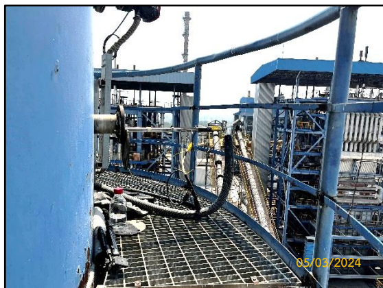
ภาพที่ 3.12 การตรวจวัดฝุ่นละออง (TSP) และก๊าซซัลเฟอร์ไดออกไซด์ (SO 2 ) บริเวณปล่อยระบายจากหม้อไอน้ำ
