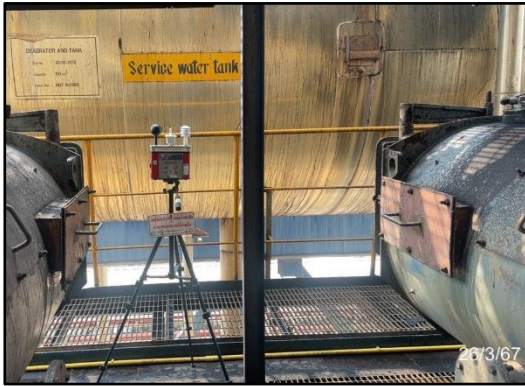
ภาพที่ 3.101 การตรวจวัดความร้อนในสถานที่ทำงานบริเวณหน่วยผลิตไอน้ำหม้อไอน้ำ 3
