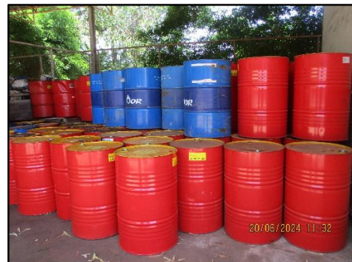
ภาพที่ 2.31 ถังขนาด 200 ลิตร สำหรับรวบรวมน้ำมันหล่อลื่นที่ใช้แล้ว
