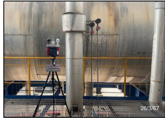
ภาพที่ 3.102 การตรวจวัดความร้อนในสถานที่ทำงานบริเวณหน่วยผลิตไอน้ำหม้อไอน้ำ 4
