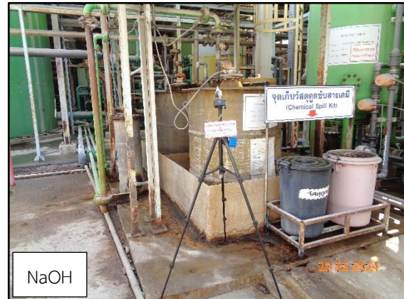
ภาพที่ 3.104 การตรวจวัดไฮโดรเจนคลอไรด์ (HCl) และโซเดียมไฮดรอกไซด์ (NaOH) ในสถานที่ทำงาน บริเวณอาคารผลิตน้ำปราศจากแร่ธาตุ
